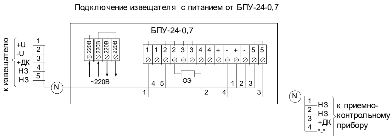
Рисунок 2.12 – Схема подключения извещателя к блоку питания «БПУ-24-0,7»
